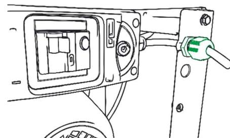
3. Ziehen Sie den Abwasserschlauch durch Ziehen nach unten so heraus dass der weiße Ring am Schlauch zu sehen ist Wenn Sie den weißen Ring nicht sehen, ist der Schlauch nicht weit genug herausgezogen! Die Schleuder wird nicht richtig funktionieren und es droht eine Beschädigung! Kürzen Sie den Schlauch nach Bedarf.
