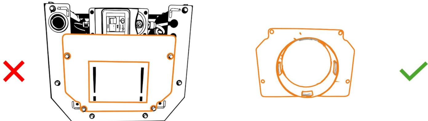
Der Ablaufschlauch befindet sich im TRANSPORTMODUS. Ziehen Sie den Schlauch nach unten, sodass er über seine gesamte Länge schräg nach unten verläuft. Die WEISSE MARKIERUNG am Ablaufschlauch muss im BETRIEBSMODUS der Zentrifuge stets sichtbar sein.
