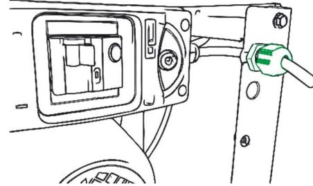
3. Tire de la manguera de desagüe hacia abajo para que pueda ver la banda blanca de la manguera. Si no ve la banda blanca, ¡la manguera no está suficientemente extendida! La centrifugadora no funcionará correctamente y existe riesgo de daños. La manguera de desagüe debe estar siempre inclinada hacia abajo. Acorte la manguera según sea necesario.
