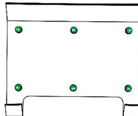
2. Asegúrese de retirar la placa de fijación del motor situada en la parte inferior de la centrífuga. Si no se retira, el producto no funcionará correctamente.
