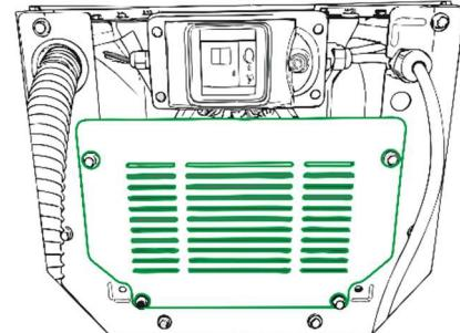
5. Aplique sellador sanitario de oruga a la placa superior alrededor del perímetro del orificio de inserción de la centrífuga.
