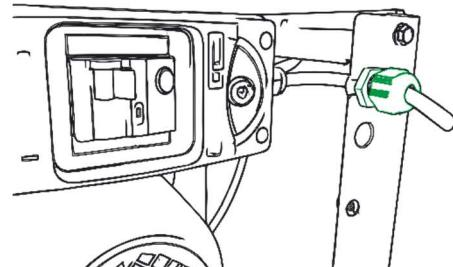
**⚠WARNING** 3. Saque la manguera de residuos tirándola hacia abajo hasta que vea la raya blanca. ¡Si no se ve la raya blanca, la manguera no está sacada lo suficiente! El secador de bañadores no funcionará bien y podrá estropearse. ¡Hay que asegurar que la manguera de desagüe tenga una inclinación a lo largo de todo su recorrido! Evitar que la manguera se doble o retuerza. Después corte la manguera de residuos según sea necesario.
