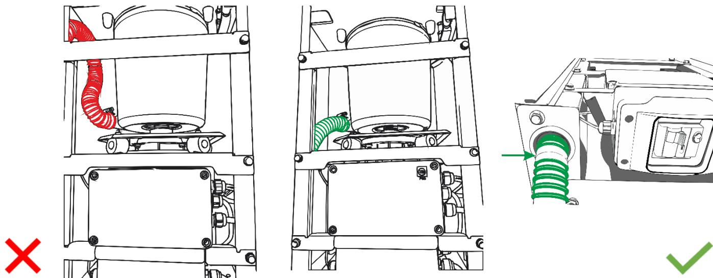
Atornille la **PLACA PROTECTORA (PROTECTIVE PLATE)** a la parte inferior de la centrífuga utilizando los tornillos de la placa de transporte del motor. La **PLACA PROTECTORA** debe permanecer instalada mientras la centrífuga esté en **MODO DE FUNCIONAMIENTO**.
