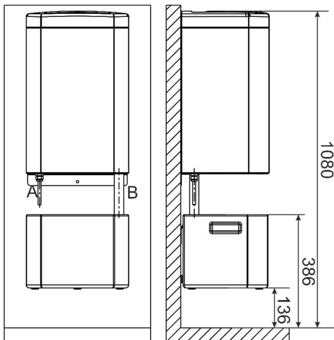
La manguera de desagüe puede desembocar en un depósito para recoger el agua montado en la pared debajo del secador. El volumen del depósito es de 18 litros de agua y hay que ir vaciándolo de forma manual cada vez que éste se llene.
