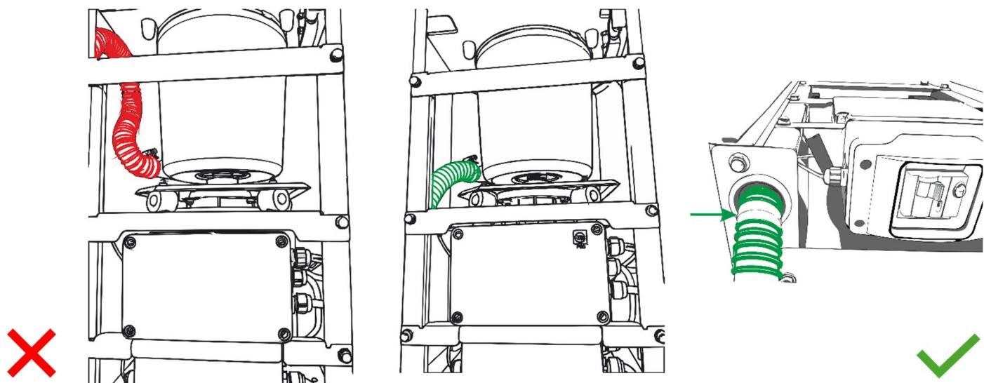
Vissez la PLAQUE DE PROTECTION (PROTECTIVE PLATE) sous l'essoreuse à l'aide des vis provenant de la plaque de transport du moteur. La PLAQUE DE PROTECTION doit rester installée pendant toute la durée d'utilisation de l'essoreuse en MODE DE FONCTIONNEMENT.
