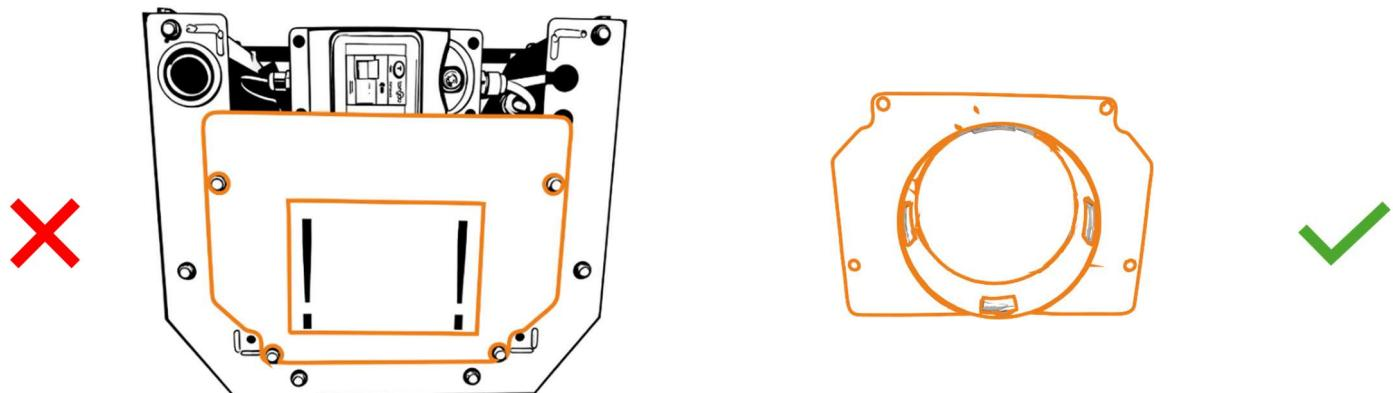
Le tuyau de vidange est en MODE TRANSPORT. Tirez le tuyau vers le bas de façon à ce qu'il forme une pente sur toute sa longueur. La MARQUE BLANCHE sur le tuyau de vidange doit rester visible pendant toute la durée d'utilisation de l'essoreuse en MODE DE FONCTIONNEMENT.
